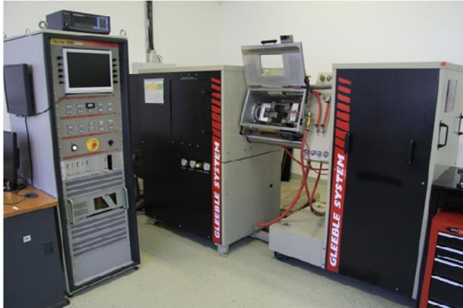
Figure 1. Gleeble 3800 Termomechanical Simulator, Gleeble labor at Dunaújvárosi Egyetem [Uniduna, 2016]
