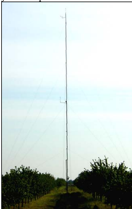
Mérő torony 2 db anemométerrel Wind measuring Tower with 2 anemometers
