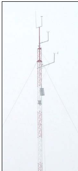
Mérő torony csúcsa az érzékelőkkel Wind measuring Tower with sensors on tip
